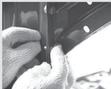
P2. Fijar con bulones y tuercas, sin ajustar aún al 100%.
